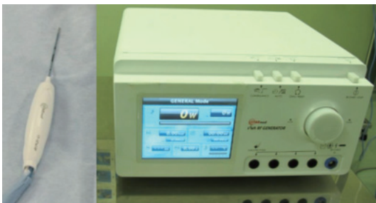
図4. RFA時に使用する道具および機器. RFA針とジェネレーター
