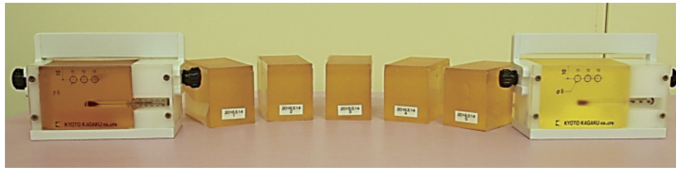
図6. 乳房超音波精度管理用ファントムの色調変化. 左: 旧ファントム, 中央5つ: 未使用ファントム(音響特性計測は左端ファントムを使用), 右: 新ファントム
